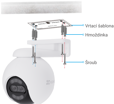
Obr. 1 Montáž na strop
